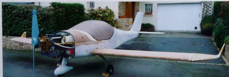
Jean-Jacques a construit son avion dans son garage. En haut, tronçonneuse à la main, il fabrique son hélice. Ci-dessus, l'avion après trois ans et demi de construction. A droite, le moteur diesel de Peugeot 106, 1400 cm 3 avec réducteur fabriqué maison.
