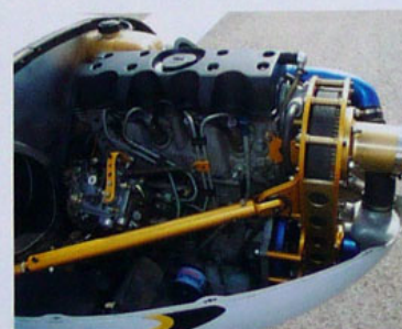
Jean-Jacques a construit son avion dans son garage. En haut, tronçonneuse à la main, il fabrique son hélice. Ci-dessus, l'avion après trois ans et demi de construction. A droite, le moteur diesel de Peugeot 106, 1400 cm 3 avec réducteur fabriqué maison.
