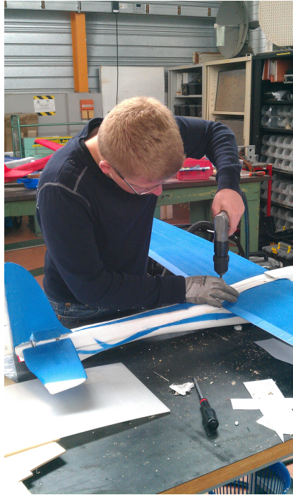
FIGURE 4.10 – Fixation de la voilure sur le fuselage
