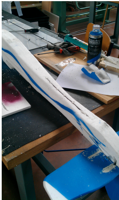
FIGURE 4.9 – Renfort de la partie arrière du fuselage
