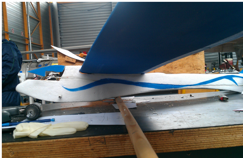
FIGURE 5.1 – Détermination du centre de gravité
