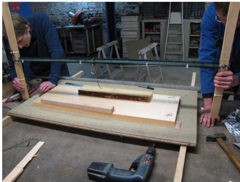
FIGURE 4.1 – Mise en oeuvre découpe au Fil Chaud
